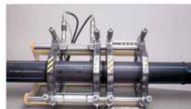
Fase 5: Saldatura con gli elementi in pressione.
