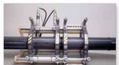
Phase 5: soudure avec les éléments en pression
