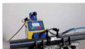
Avviare la saldatura. Effettuare i controlli previsti (allineamento, profondità di inserimento e indicatori di fusione).
